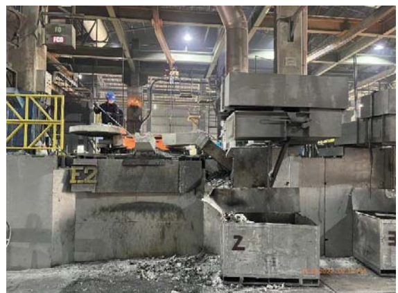
ภาพที่ 18 เตาหลอมแบบเหนียวไฟฟ้า (เตาหลอมหลัก)
