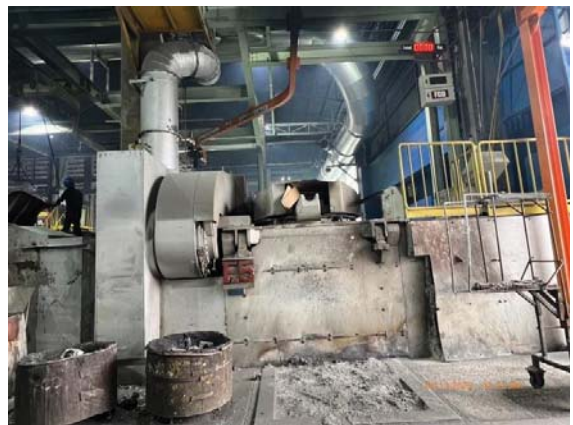
ภาพที่ 64 เตาหลอมแบบเหนี่ยวนำไฟฟ้า (เตาหลอมสำรอง)
